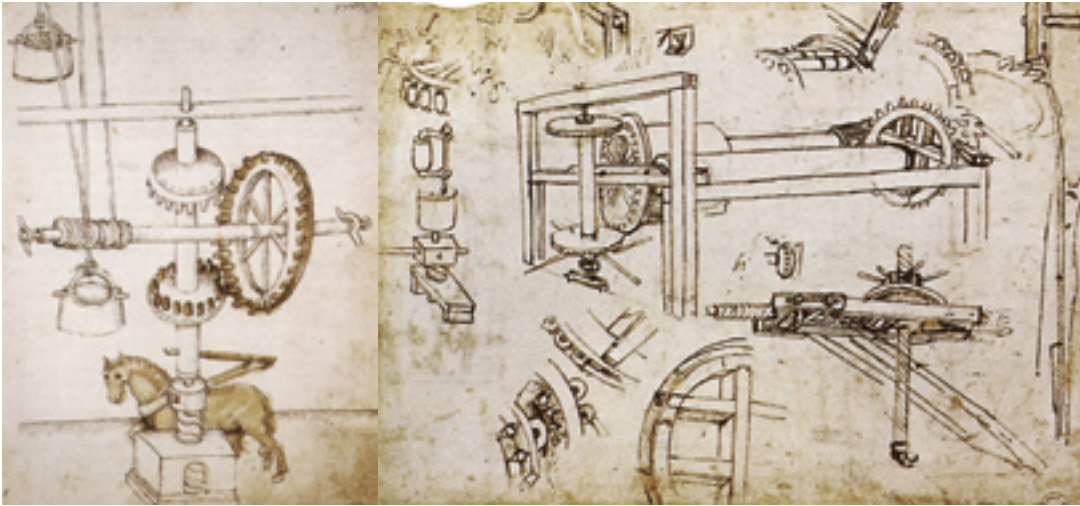
塔奎拉绘制的由一匹马驱动的牛力吊车 牛力吊车上部第二组滑轮示意图
