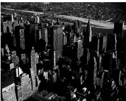
图6 曼哈顿岛是阴影问题最显著的一个例子，因为密度过高“光表面”发生了戏剧性的变化，产生了许多终年没有阳光的建筑立面。这种现象在照片中的区域最为明显。
