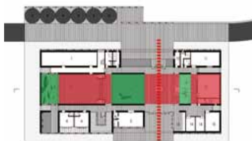
图14 三个主要室内空间之间分别插入3个天井式内院，形成建筑与自然的叠加
