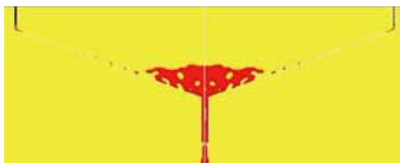
图10 膜面积水CFD模拟
