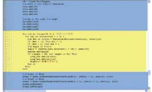
脱繁重的手工建模工作。以前在有曲面复杂形体的建筑中，结构工程师要手工用直线段离散大量的B样条曲线、圆弧段进行计算，这个工作现在也可以由插件的功能实现自动生成（图28~30）。杆件生成后的下一个步骤是检查桁架连杆间的夹角，保证所有的夹角在 $30^{\circ} \sim 60^{\circ}$ 之间（图31），有良好的力学性能且便于焊接。几万根杆件瞬间即可完成检测。杆件定位的几何数据符合数控加工的标准，对特殊的节点做有限元应力分析。而以前对于这种问题，可能直到钢结构公司出施工详图的时候才能被发现。
