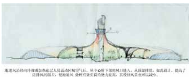
图8 四季厅地道风系统的示意图
