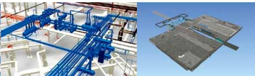
图2 山东济南火车西站地下车库管线综合
