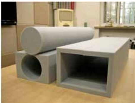
图9 声学材料三聚氰胺吸声体
