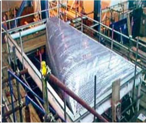
图8 热阻丝将气枕切割开的实验
