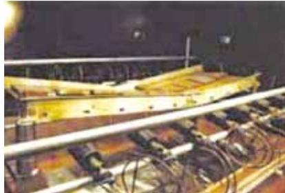
图4 防火试验后的镀锌钢梯架
