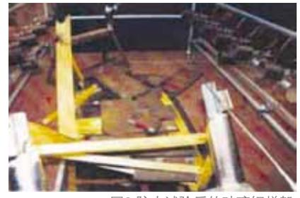
图3 防火试验后的玻璃钢梯架
