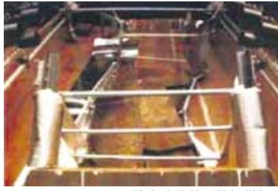
图2 防火试验前后的铝梯架
