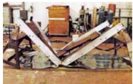
图6 防热辐射试验后的铝梯架
