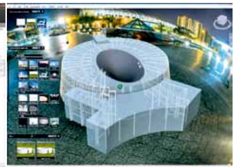
图5 体块模型导入Showcase模拟真实光环境下幕墙玻璃观感
