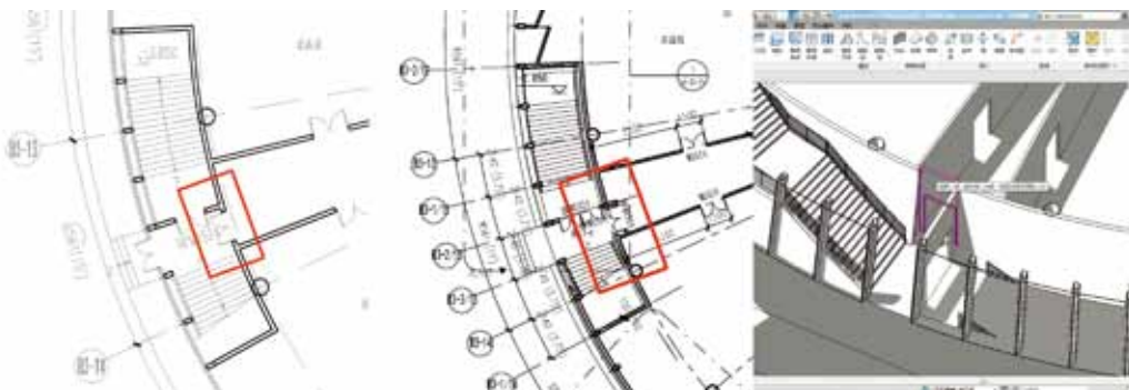
图6 扩初阶段CAD图纸、Revit导出的二维图纸、红框位置对应的墙体三维模型的对比
