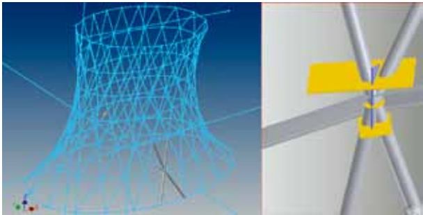
图10 Revit单线模型导入Inventor并按专家意见进行节点设计尝试
