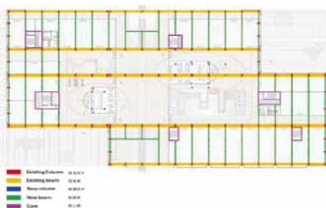
图12 插层与原结构相连
