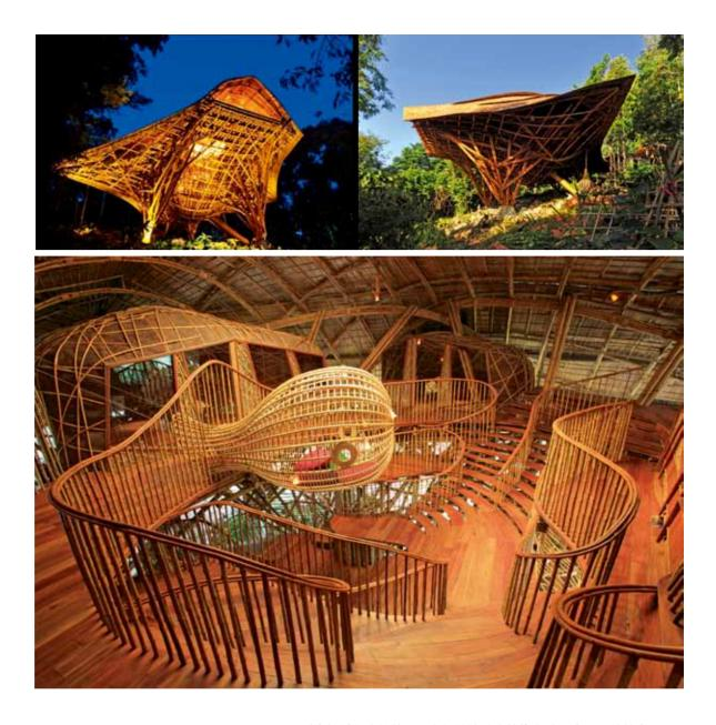
了实现更好地对流通风,结构上将底层适当抬高。这样建筑对自然环 境的影响也达到了最小化。8m高的屋顶悬挑着就像一把大伞遮风避 雨,其中心还设有玻璃天顶,可以充分接收自然光,极大减少了建筑 的能源消耗。
