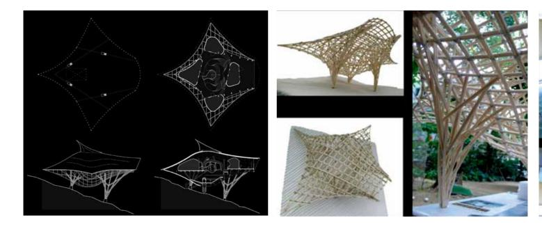
都将使用石头或混凝土建造房子。这个项目旨在改变竹子的坏名 声,同时向人们和其他建筑师展示竹子是一种多么令人赞叹的优异 建材,竹子也是适合现代建筑的。此外,竹子是最绿色环保的建筑 材料之一。它在生长4~5年后,就可以达到建筑结构要求的强度。 由于竹类植物每年都长出新笋,在收割了生长4~5年的竹枝后它也 不会死。这是一个持续不断的收获、成长过程。相比生长超过40年 才能满足结构强度要求的树木来说,这是一个巨大的优势。
