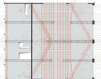
图15 底层楼板预应力钢筋布置
