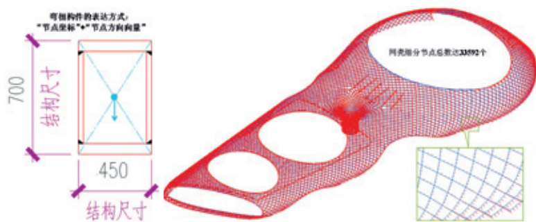
图17 弯扭构件的图纸表达
