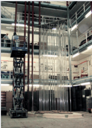
图5 在BRE 建造的装饰亭部件等尺寸模型
