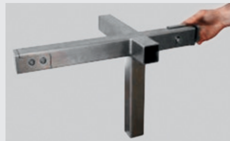
图3 屋顶连接部分的等尺寸模型
