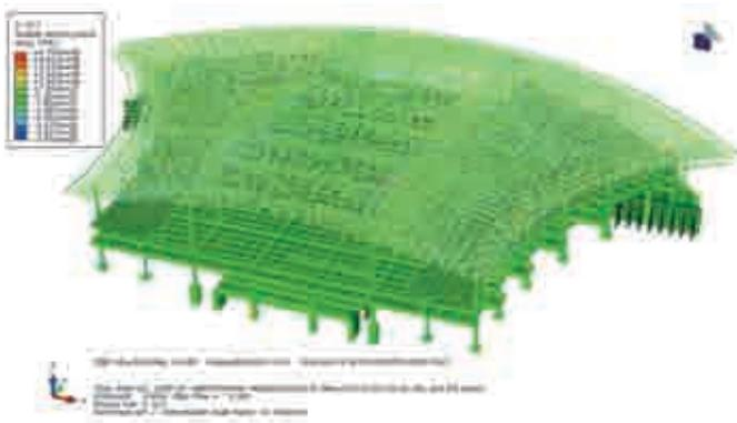
图25 基于BIM的结构动力弹性分析
