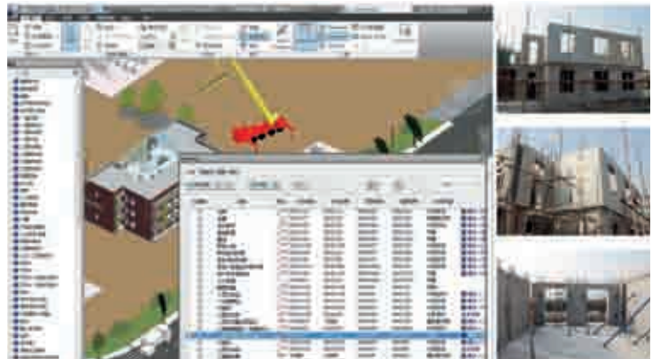
图17 Navisworks进行施工模拟指导
