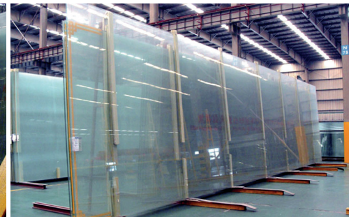
图68 15.0m × 3.65m × 19mm 超大超白玻璃原片
