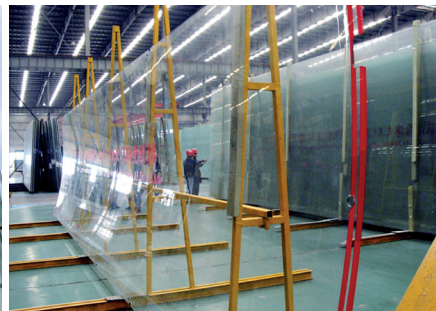
图67 13.8m × 2.85m 超大夹胶热弯钢化玻璃, 厚度12mm, 三片
