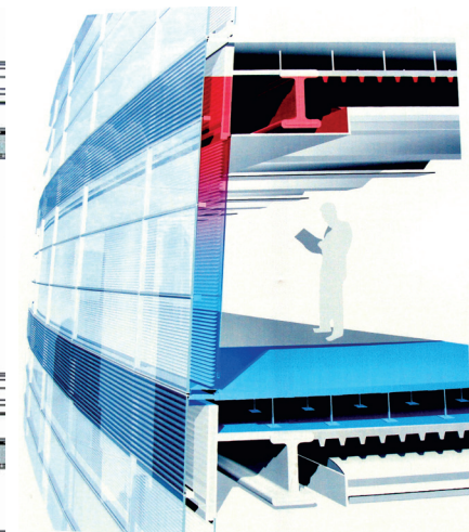
图46 通风幕墙竖向剖面
