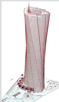
卡塔尔多哈, 阿尔比达塔, 三向杆系结构
