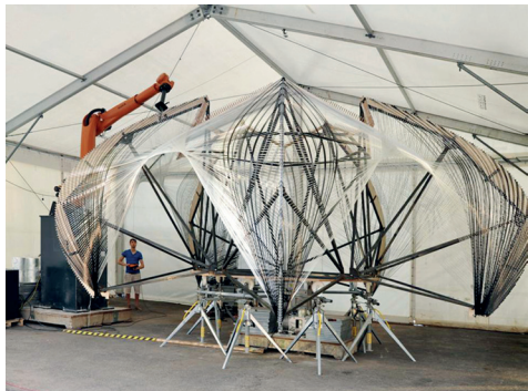
机器臂在编织工作中，骨架沿中心轴自动旋转，配合机器臂的编织动作
