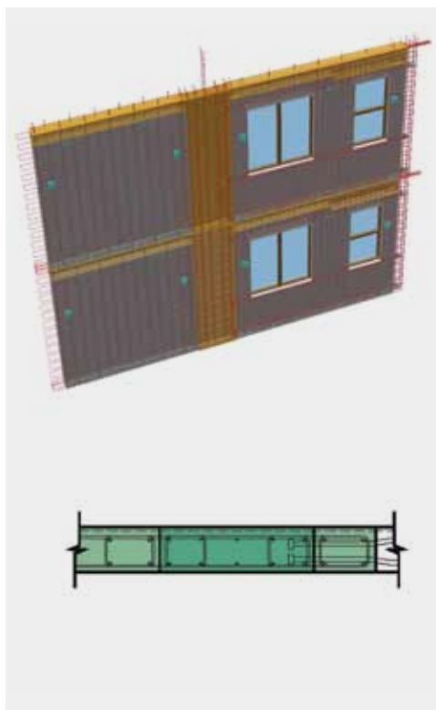
图5 “一字形”连接节点示意
