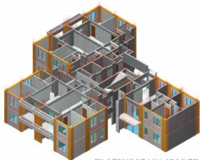
图8 应用BIM技术建立的Y-2工业化模型
