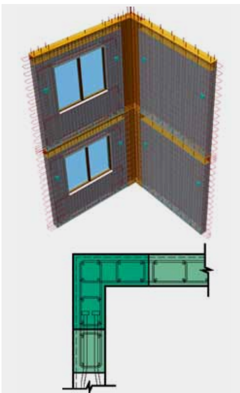
图6 “L字形”连接节点示意
