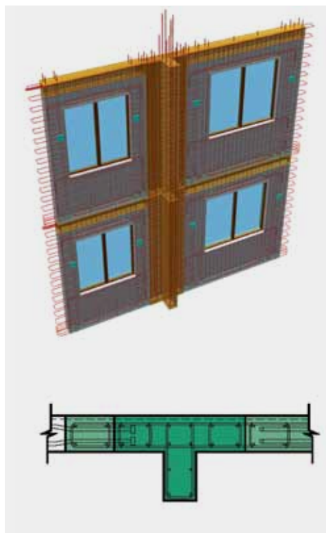
图7 “T字形”连接节点示意
