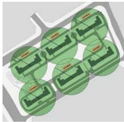
图12 塔吊布置示意图
