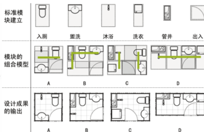
图8 由标准的单一功能模块组合成不同布局模式的卫生间
