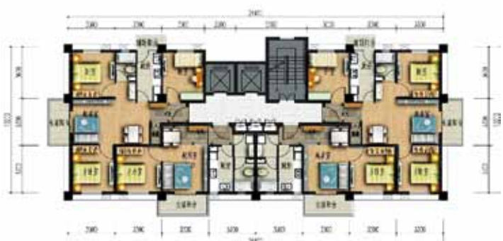
图17 B系列18层户型平面图 (三房86m 2 , 一房53m 2 )
