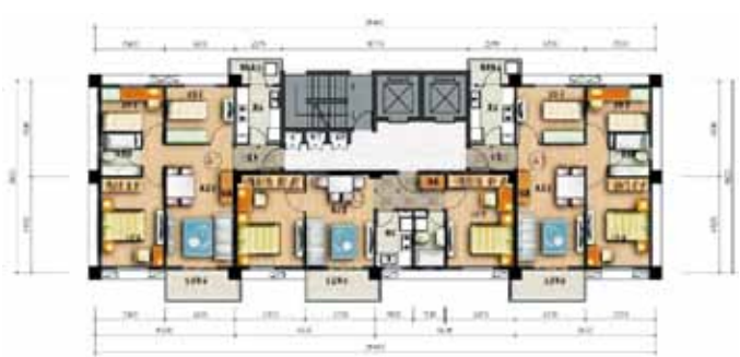
图15 A系列18层户型平面图 (三房87m 2 , 二房71m 2 )
