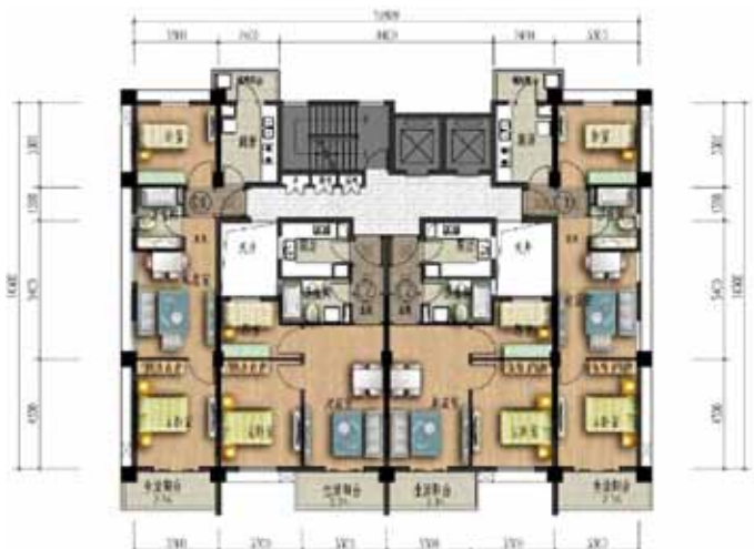
图19 C系列18层户型平面图（端头二房77m 2 ，中间二房72m 2 ）
