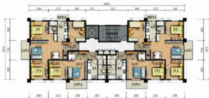
图16 B系列11层户型平面图 (三房84m 2 , 一房52m 2 )
