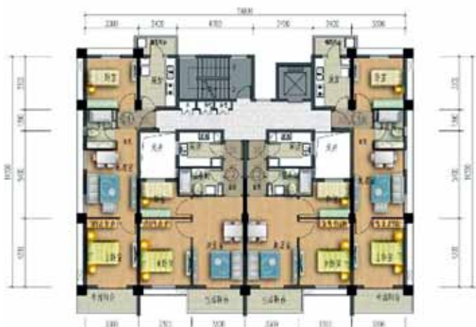
图18 C系列11层户型平面图（端头二房74m 2 ，中间二房69m 2 ）
