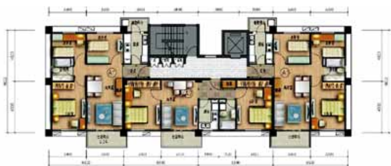
图14 A系列11层户型平面图 (三房85m 2 , 二房70m 2 )
