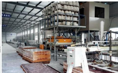
图10 GRC喷射生产线
