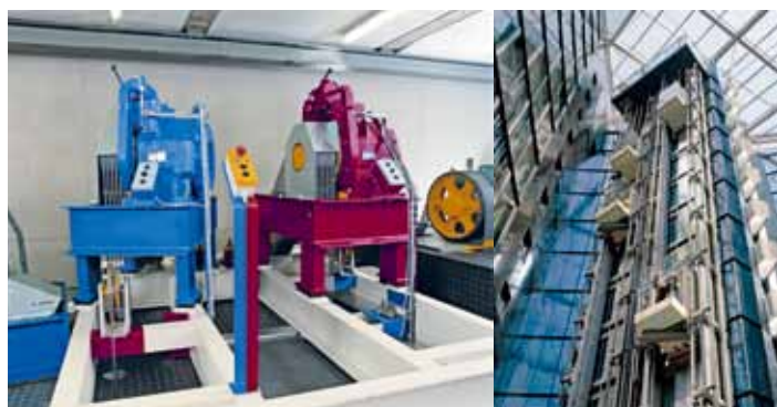
图8 双子电梯的设计理念、双主机和运行实景
