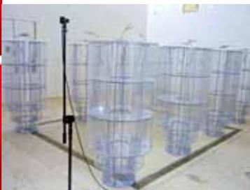
图2 圆柱型透明空间吸声体
