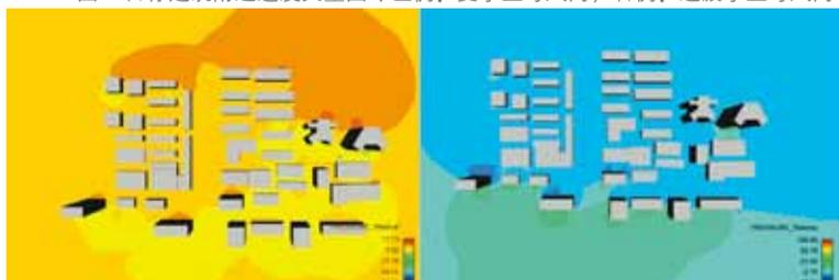
图5 计算区域室外压力分布云图（左侧：夏季主导风向；右侧：过渡季主导风向）
