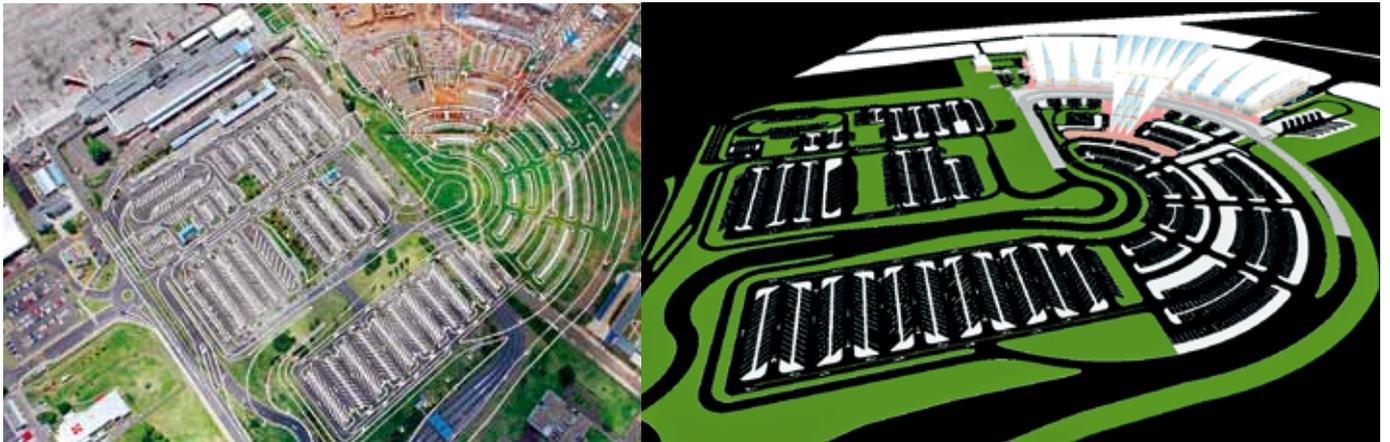
图3 航拍与BIM结合检查空侧、陆侧施工进度
