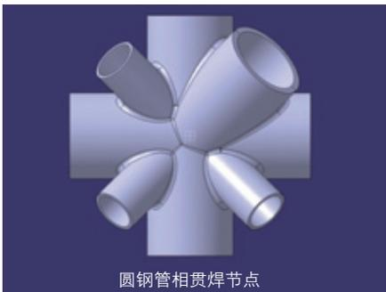
圆钢管相贯焊接节点
