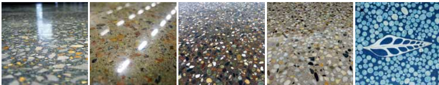
打磨露出的骨料突显混凝土的自然之美
