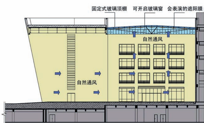
图13 南面中庭空间空气对流设计
