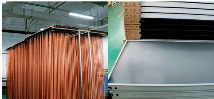
图10 平板太阳能流水线生产车间
