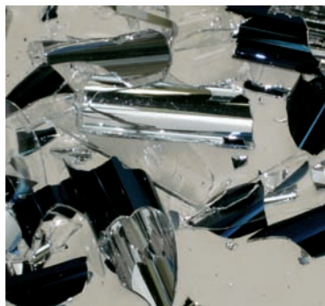
图8 集热器真空管的破坏现状
