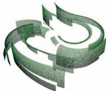
幕墙深化阶段参数化设计团队提供的石材排布模型
